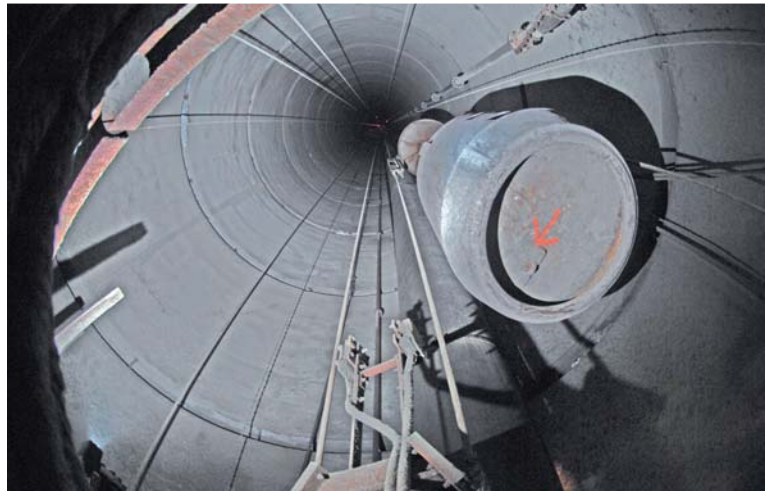
S. 44: Blick vom Anschlag Unterfahrung in den Teufturm mit Kippeinrichtung und Seilscheibenbühne
